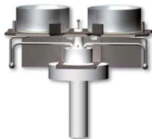
Figure 46 : Schéma de la DSC 131 de SETARAM.
