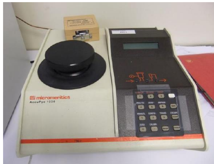
Figure 44 : Pycnomètre à Hélium Accupyc 1330 de Micrometrics.
