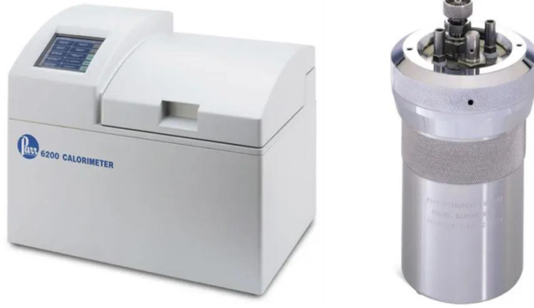
Figure 48 : Calorimètre Parr 6200 (à gauche) et bombe calorimétrique (à droite).
