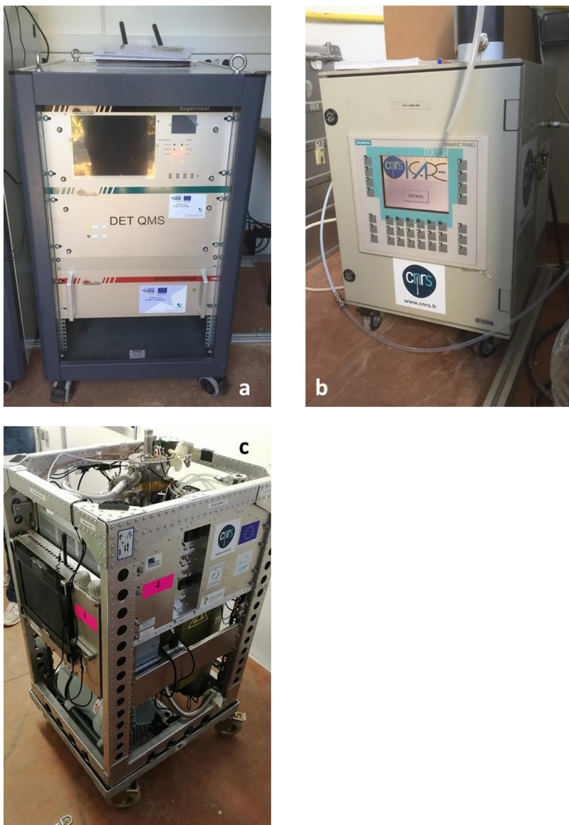
Figure 5-2 a), airmoSCAN XPERT, Chromatotec® ; b), dispositif d'échantillonnage des COVO ; c), spectromètre Infra-Rouge In situ Toute altitude (SPIRIT)
