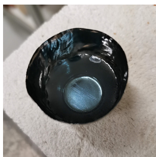
(a) Verre recuit après la seconde fusion.
