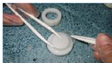
FIGURE III. 15 : Dispositif de DGT en cours d'ouverture et enlèvement du gel diffusif
