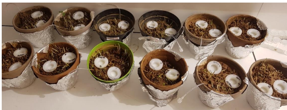
FIGURE III. 14 : Photo des dispositifs des DGT insérés dans les pots des sols
