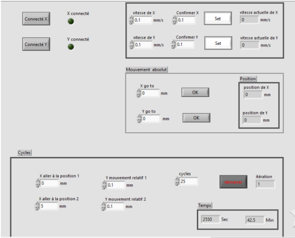
Image : Exemple de traitement d'une surface carrée de 5mm de largeur par l'interface LabVIEW
