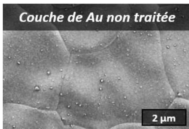
Figure V.20 : Images MEB de la surface non traitée de l'or Au.
