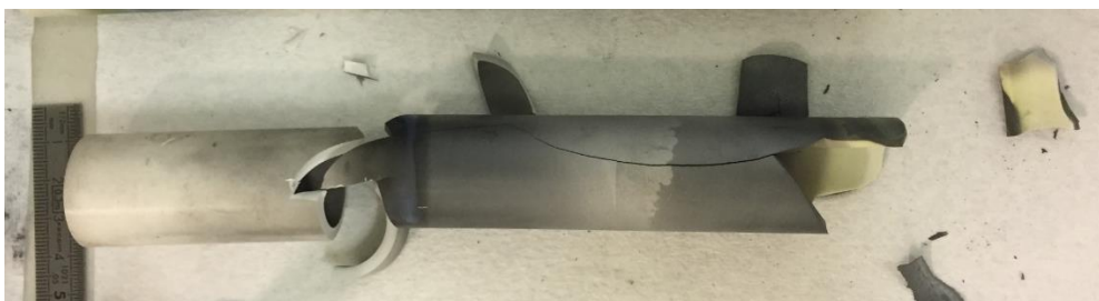
Figure II-9 : Tube séparateur en zircone Y-FSZ fracturé.
