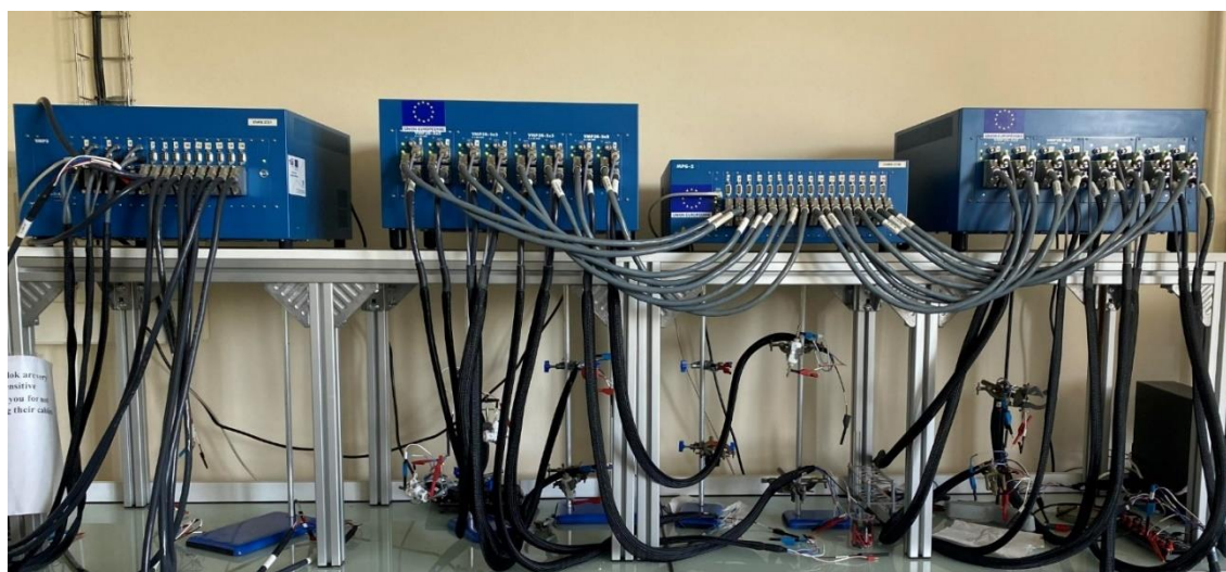
Figure 39 : Image des potentiostats utilisés pour les tests électrochimiques
