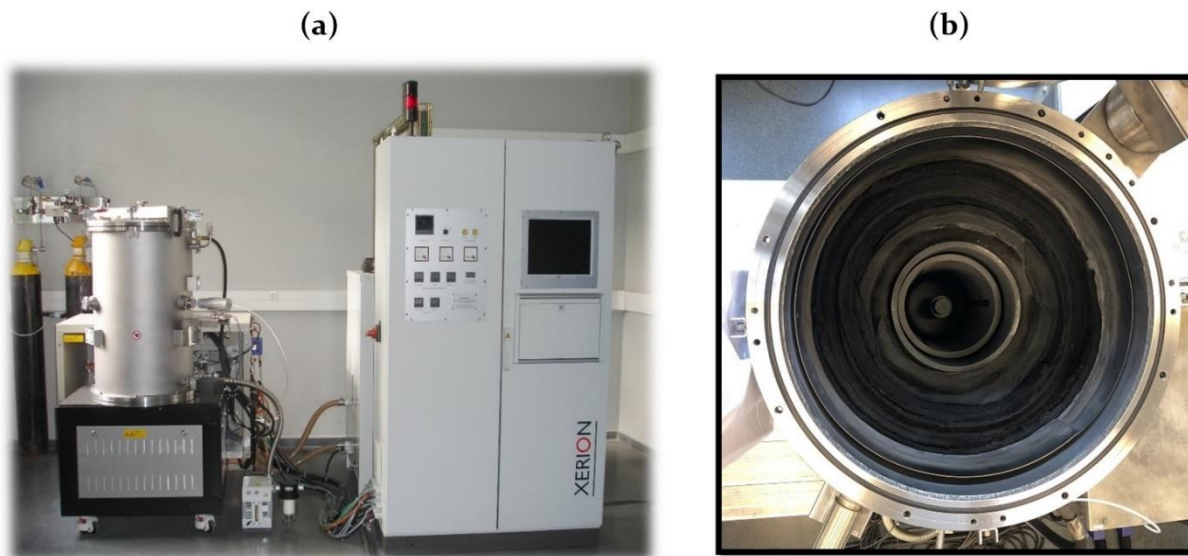
Figure 21 : (a) Image du four à l'institut INCAR en Espagne et (b) du porte échantillon.
