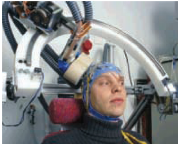
FIGURE 1.23 – Prototype pour la SMT assistée par ordinateur au laboratoire BioMag [Ruohonen, 1998]
