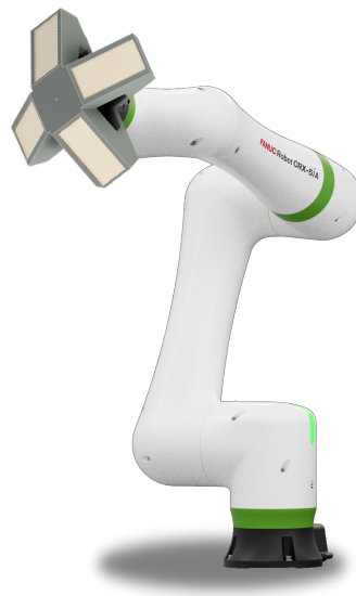
FIGURE P.4 – Le robot collaboratif (cobot) Fanuc CRX-5 i A de Fanuc
