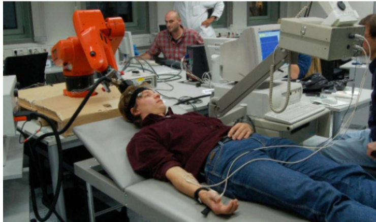
FIGURE 1.16 – Robot Kuka porte sonde pour la stimulation transcrânienne [Ruohonen, 1998]
