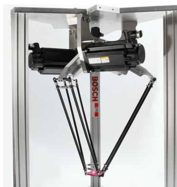
FIGURE 1.29 – Le robot parallèle de type Delta [Clavel, 1987]
