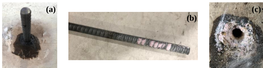
Figure 64 : Photo montrant l'ancrage avant son arrachement (a) et sa rupture en adhérence à l'interface résine/acier ((b) et (c))
