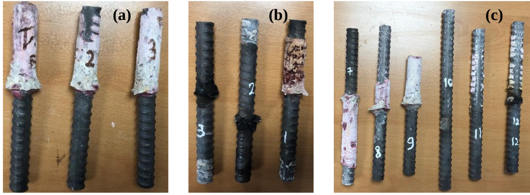
Figure 65 : Photos des différents modes de ruine à température ambiante (a), à haute température (b) et après exposition au feu (c)
