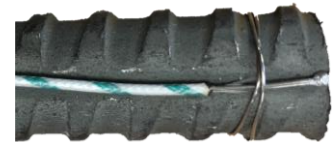
Figure 45 : Thermocouple fixé sur une armature de type GEWI
