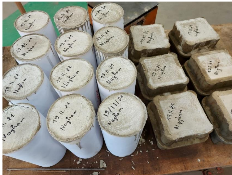
Figure 59: Exemples d'éprouvettes cubiques et cylindriques pour la caractérisation du béton pour la deuxième campagne d'essais
