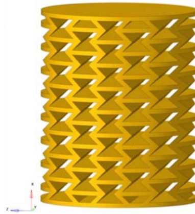
FIGURE 3.14 – Modèle numérique de la SA utilisée pour l’impact sur pendule.
