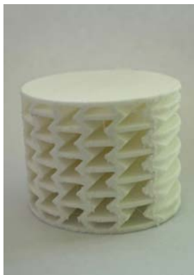
(a) Petite SA. Hauteur D_0 = 2.747 \times 10^{-2} m, diamètre 3.5 \times 10^{-2} m, masse 1.35 \times 10^{-2} kg.
