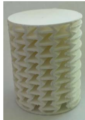
(b) Grande SA. Hauteur D_0 = 4.284 \times 10^{-2} m, diamètre 3.5 \times 10^{-2} m, masse 2.10 \times 10^{-2} kg.
