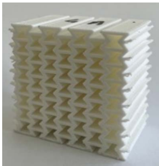
FIGURE 4.8 – Échantillon auxétique ré-entrant pour le test en compression quasi-statique (hauteur : 4.28 \times 10^{-2} m).
