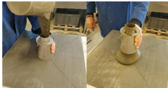
Figure 3.11 : Essai d'étalement au mini cône d'Abrams.
