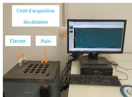
Figure 3.13 : Microcalorimètre isotherme à 8 puits.
