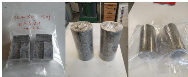
Figure 3.10 : Eprouvettes enveloppées d'un film alimentaire puis emballées dans des sacs en plastique.
