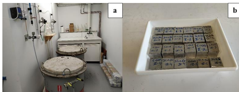
Figure 3.27 : (a) Chambre de carbonatation (b) échantillons utilisés pour le test de carbonatation accélérée.
