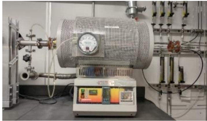
Figure 35 - Photo du four tubulaire utilisé pour l'insertion de graphène dans les structures poreuses (réacteur CVD)
