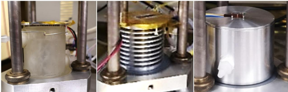
Figure 56 - Évolution de la source froide du ZT-mètre : a) un bloc en polymère, b) un bloc en aluminium avec des ailettes et c) un bloc en aluminium sans ailettes
