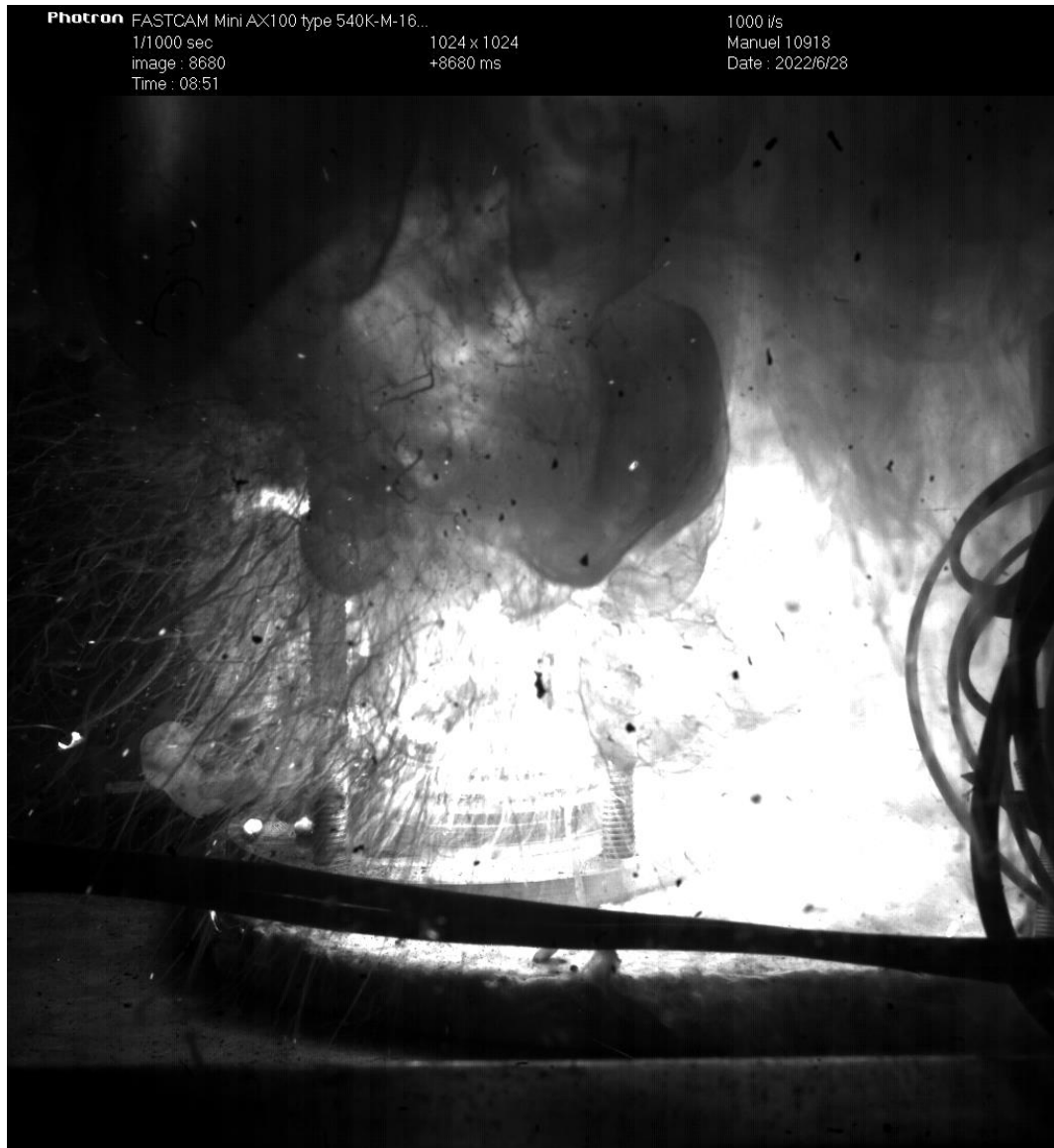
Figure 5.18 : Image caméra à t=1 s montrant le comportement virulent de la combustion
