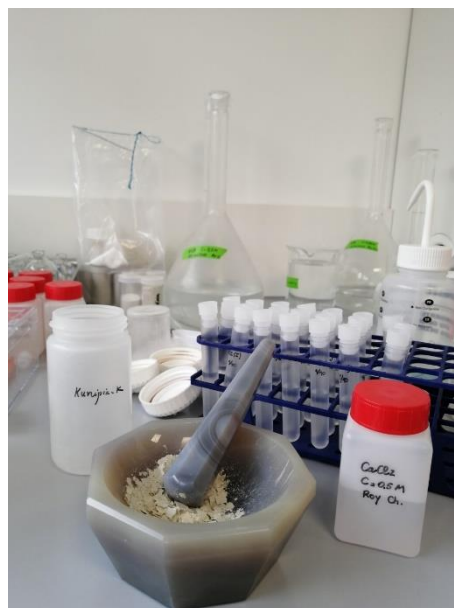
Figure II.5: Broyage manuel de la Kunipia dans un bol en agate.
