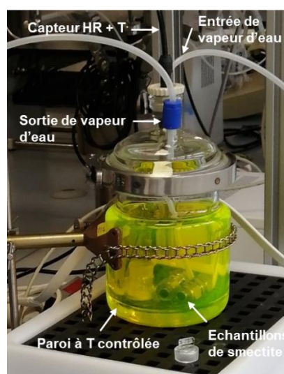
Figure III.29: Enceinte hermétique contenant les échantillons de smectite compacté
