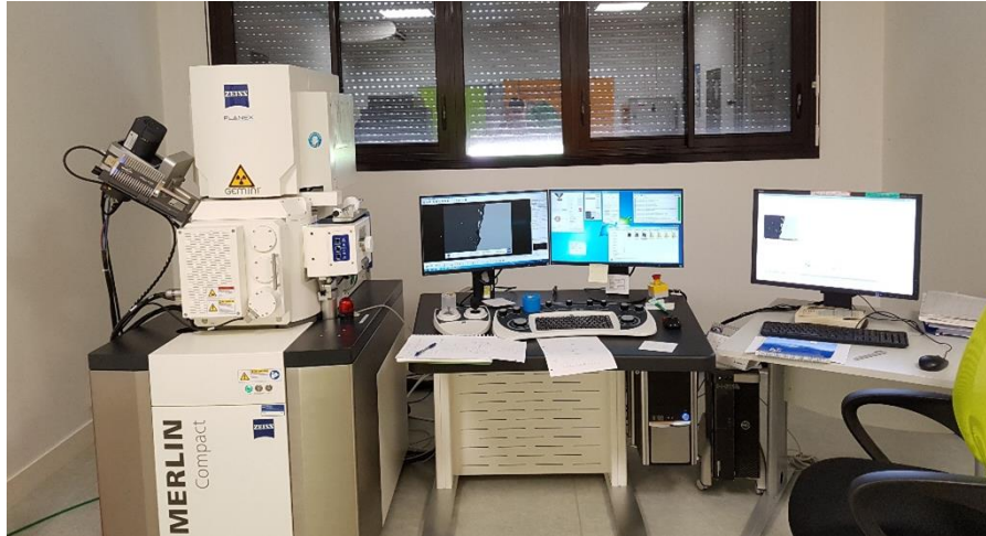
Figure 26 : Photo setup microscope électronique à balayage Zeiss (ISTO).
