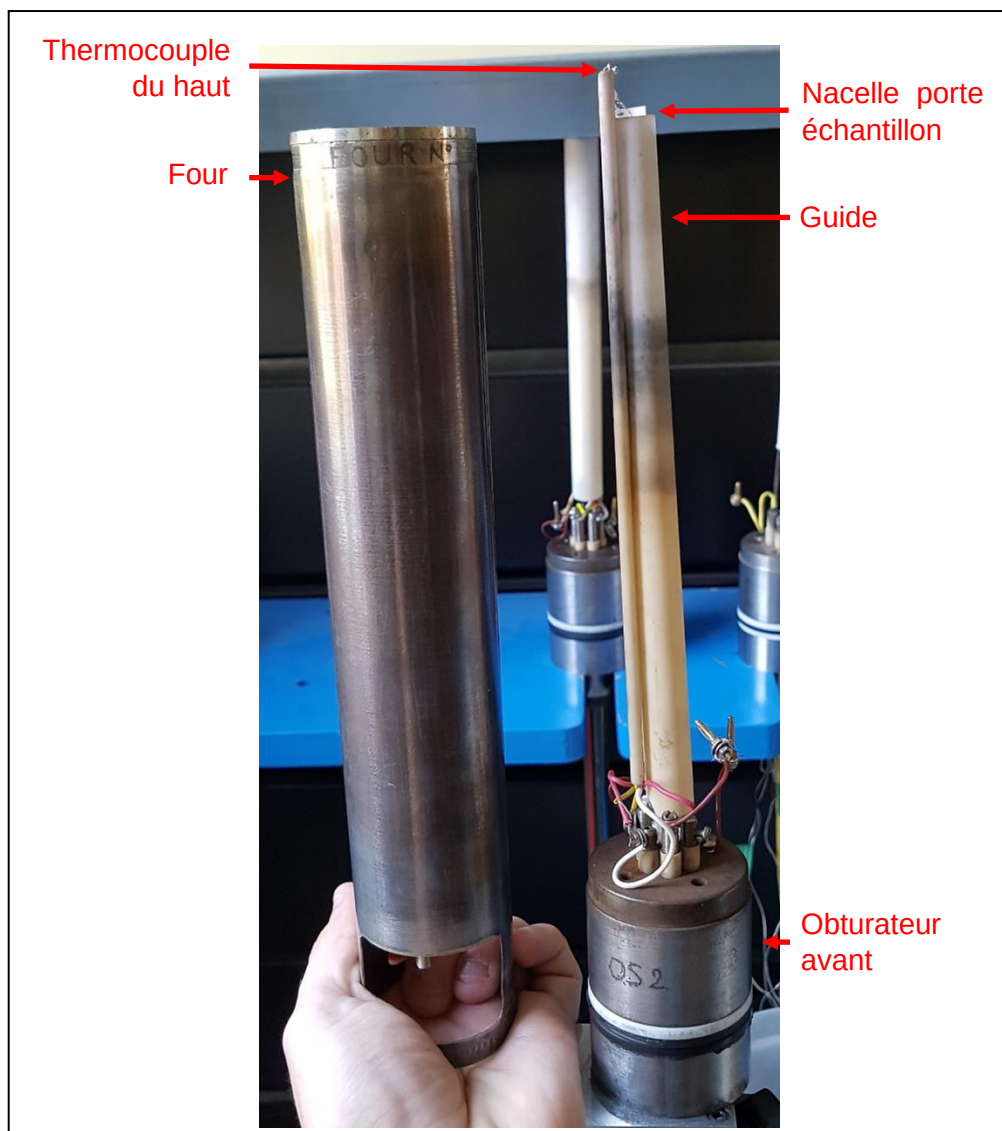
Figure 22 : Photo d'un obturbateur avant, surmonté par les thermocouples et cannes de trempes enchemisés dans des gaines en alumine. On entrevoit au sommet du guide en alumine la nacelle contenant les échantillons suspendus au fil de trempe en platine.
