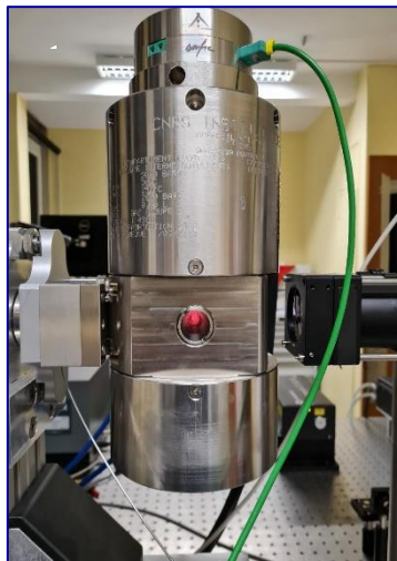
Figure 22 : Autoclave à fenêtre en marche à haute température (>700°)
