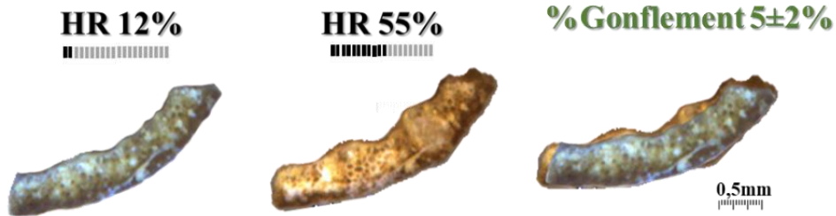
Figure III. 1 : Superposition d'un même brin de paille de blé dans le sens transversal dans deux conditions à 12% et à 55% HR
