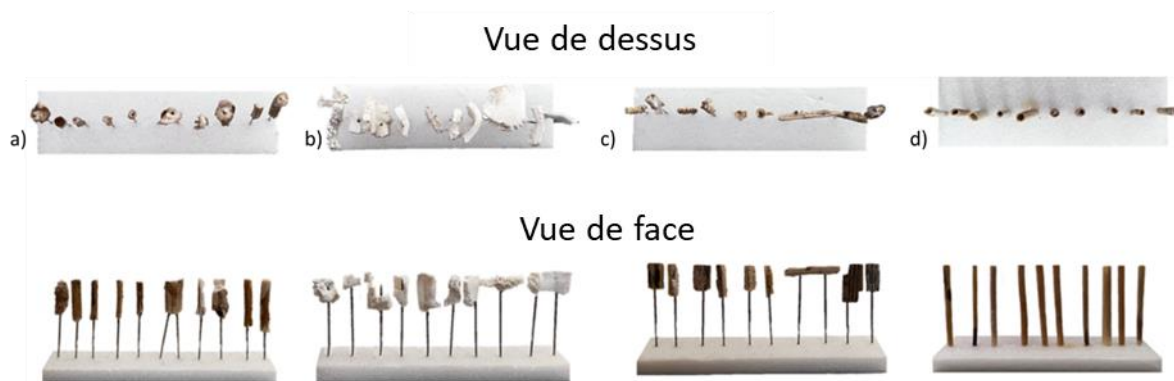
Figure II. 5 : Vue de face et vue de dessus des 4 types de granulats préparés sur le support a) paille de blé, c) paille de colza, c) écorce de tournesol et d) moelle de tournesol
