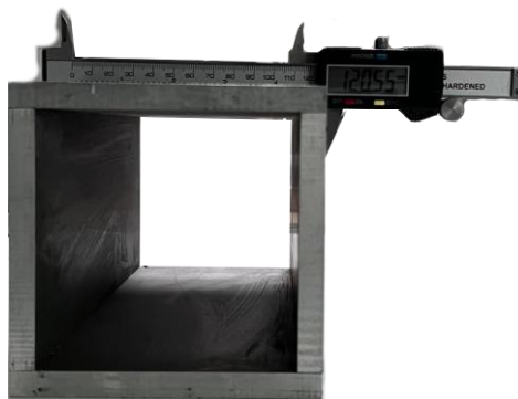
Figure II. 13 : Epaisseur du solide utilisé pour l'initialisation des capteurs laser de déplacement
