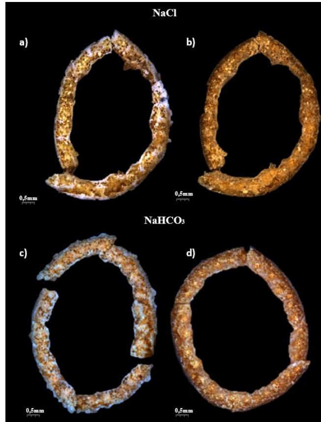
Figure III. 26 : Surfaces des granulats traités : a) et c) avant rinçage et b) après 5 minutes de rinçage pour NaCl et d) après 20 minutes de rinçage pour NaHCO 3 .
