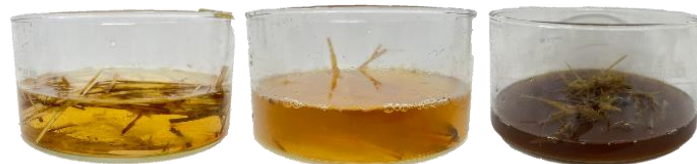
Figure III. 23 : Changement de couleur après 3 jours de la paille de blé non traitée, traitée au \text{NaCl} et au \text{NaHCO}_3 (de gauche à droite)
