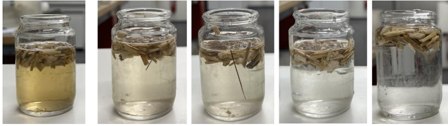
Figure III. 24 : Le processus de rinçage et la variation de couleur des granulats traités à l'écorce de tournesol avec \text{NaHCO}_3 (de gauche à droite).
