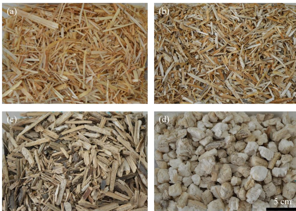
Figure 2. 2 : Photos des granulats végétaux étudiés : (a) paille de blé (WS), (b) paille de colza (RS), (c) écorce de tournesol (SB), and (d) moelle de tournesol (SP) à leur état initial après broyage
