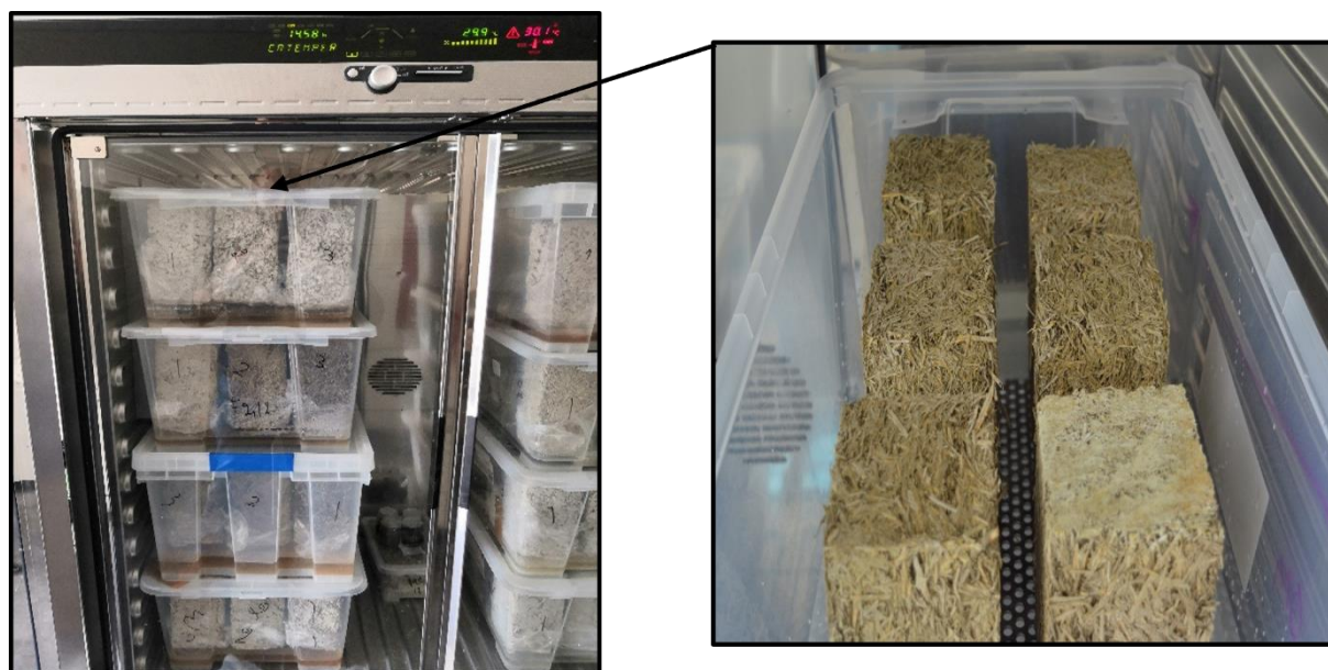
Figure 2. 5 : Conservation des échantillons sous des conditions accélérés pour le développement microbien
