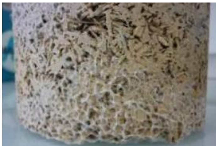
Figure 1. 31 : Développement des microorganismes après conservation des biocomposites à 30°C et 98% hr [17] [102]
