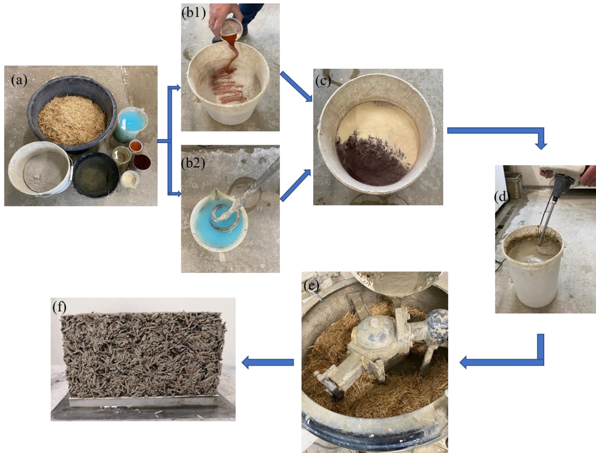
Figure 2. 4 : Processus de fabrication : (a) préparation des matériaux, (b1) ajout de la poudre de cuivre à la chaux, (b2) dissolution du sulfate de cuivre (II), (c) ajout de l'hémoglobine et de la caséine (cette étape est uniquement pour WaL), (d) mélange du liant, (e) mélange des composants, et (f) moulage des matériaux (exemple sur RL)
