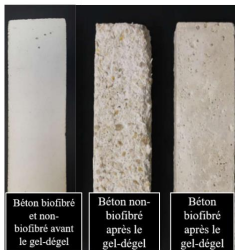
Figure 1. 23 : Photos des éprouvettes des bétons avant et après les 300 cycles de gel-dégel pour les bétons biofibrés et non-biofibrés [52]
