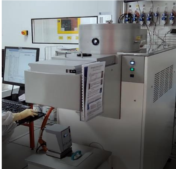
Figure 29 : Schéma représentatif et photo prise du réacteur ICP de gravure Corial 200IL.
