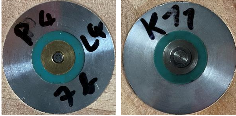
Figure 2-4 : Montage des capteurs piézorésistifs (gauche) et piézo-électrique (droite) dans leurs inserts.
