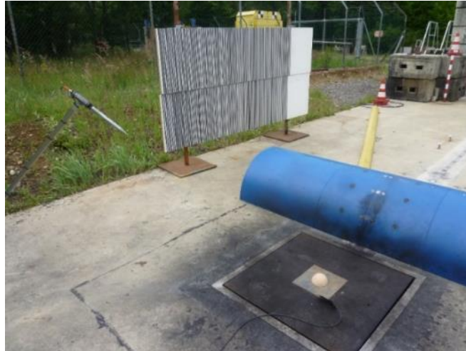
Figure 2-13 : Photo de l'installation avec une charge de 400 g de TNT à 0,53 m de l'hémicylindre.
