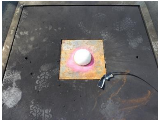
Figure 2-9 : Placement d'une charge de 333 g d'Hexomax® sur la plaque porte-échantillon.
