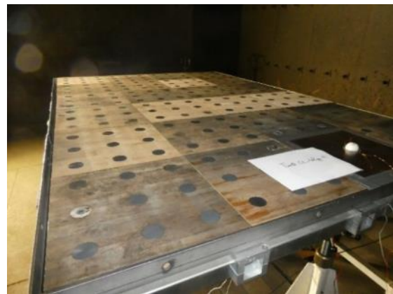
Figure 2-1 : Vue éclatée de la table à détonation utilisée lors des essais de l'IRSN, d'après [124], et photo de la table lors d'un essai en champ libre de la campagne expérimentale 9.
