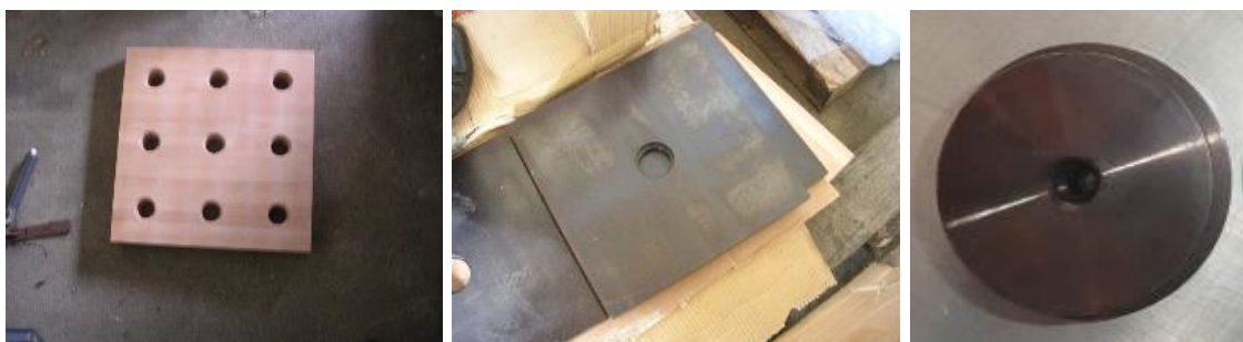
Figure 2-2 : Plaque en bois modulaire (gauche), plaque d'acier sacrificielle (centre) et support de charge et détonateur (droite) composant la table à détonation de l'IRSN.
