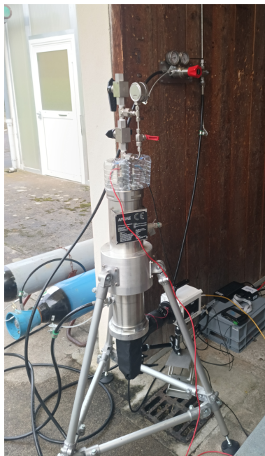
FIGURE 7.1 – Configuration de l'enceinte pressurisée et ses instruments et son schéma représentatif.
