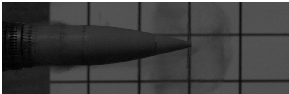
FIGURE 8.3 – Position de référence du projectile lorsque la perte d'étanchéité a lieu.
