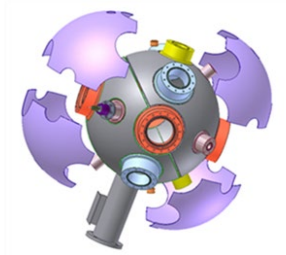
Figure II-1 : Vue éclatée de la bombe sphérique de 56 L avec les deux sphères concentriques
