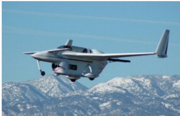
Figure I-15 : Photo du premier vol d'un avion équipé d'un système de propulsion PDE, développé par une équipe du laboratoire de recherche de l'US Air Force tirée de (« Pulsed detonation engine flies into history > Wright-Patterson AFB > Article Display » 2008)
