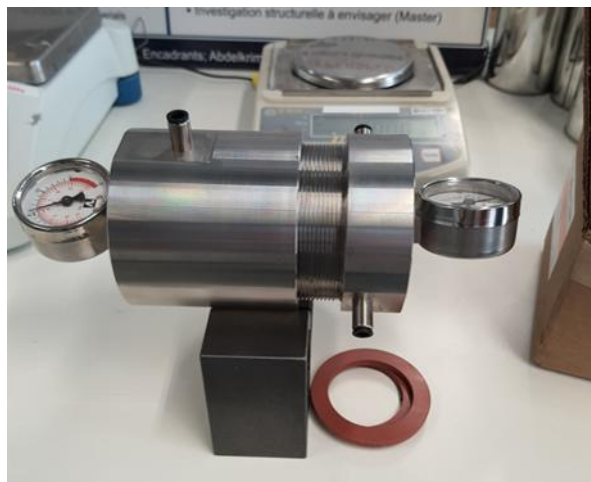
Figure 2-13 : Schéma du dispositif expérimental pour les mesures de diffusion du \text{CO}_2 (a) et photo de la cellule de diffusion (b).
