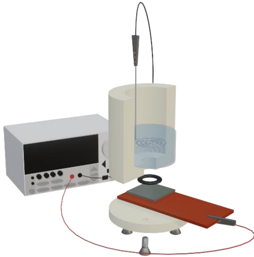
Figure n°I-8 : Représentation d'une cellule électrochimique traditionnellement utilisée au laboratoire. Elle comporte un contact électrique en face arrière assuré par une plaque de cuivre et une contre-électrode plongée dans l'électrolyte, faite d'un fil de platine. Le substrat est au contact de l'électrolyte via une ouverture de cuve surmontée d'un joint. Le système est maintenu par 3 vis et est relié à un générateur de courant via des fils terminés par des pinces crocodiles.
