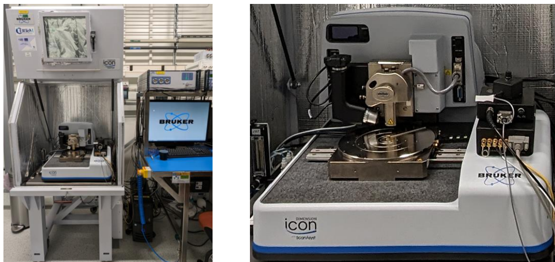
Figure n°III-10 : Photographie du microscope à force atomique (AFM)
