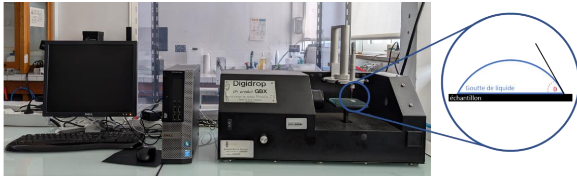
Figure n°III-12 : Dispositif de mesure d'angle de goutte
