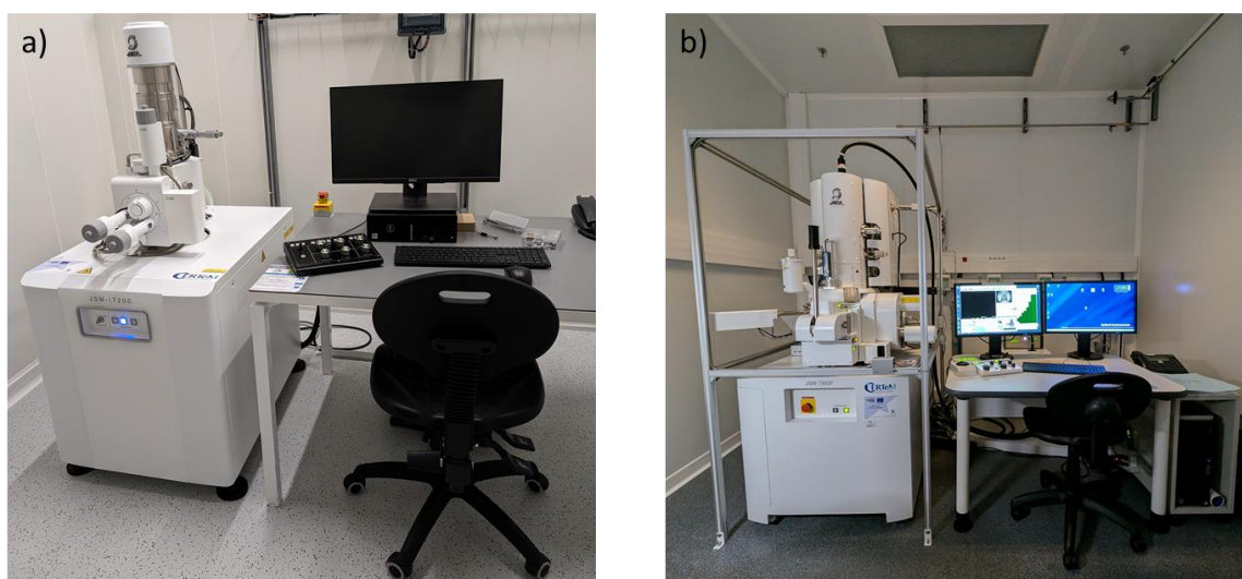
Figure n°III-11 : Photographie a) du microscope électronique à balayage de table et b) du microscope électronique haute résolution
