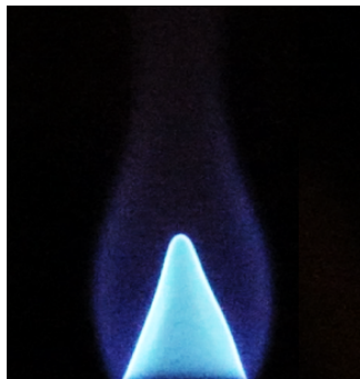
Figure 11 : Photographie d'une flamme conique provenant du brûleur du GREMI utilisé pour cette étude.
