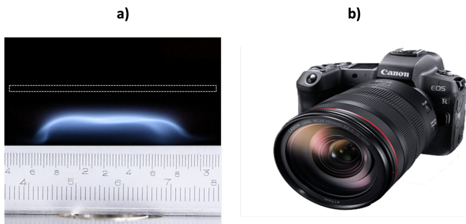
Figure 41 : Montage expérimental utilisé pour capturer des images de la flamme, a) image d'une flamme avec mire (règle) utilisée pour la calibration et, b) un appareil photo Canon EOS 6D Mark II.
