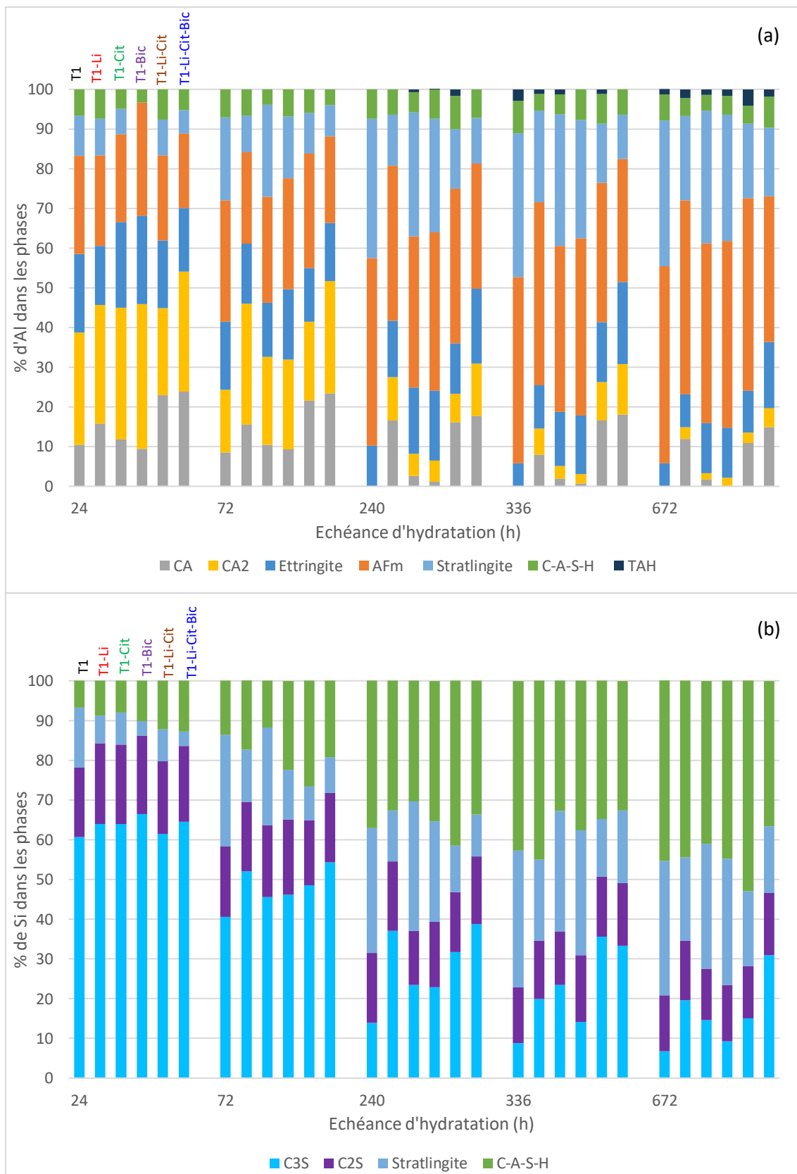
Figure 137 : Pourcentages d'aluminium (a) et de silicium (b) dans les phases anhydres et hydratées obtenus par RMN entre 24 heures et 28 jours pour les systèmes T1, T1-Li, T1-Cit, T1-Bic, T1-Li-Cit et T1-Li-Cit-Bic
