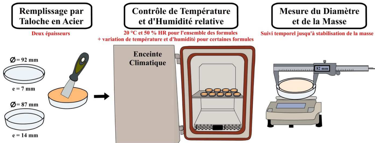
Figure 78 : Schématisation de la démarche suivie pour l'évaluation du retrait diamétral
