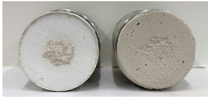
Figure 101 : Rupture adhésive d'un échantillon représentatif de la formule -AC après la réalisation de l'essai d'adhérence sur le support en BA13 peint
