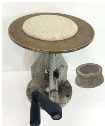
Figure 23 : Test de consistance avec la table à choc
