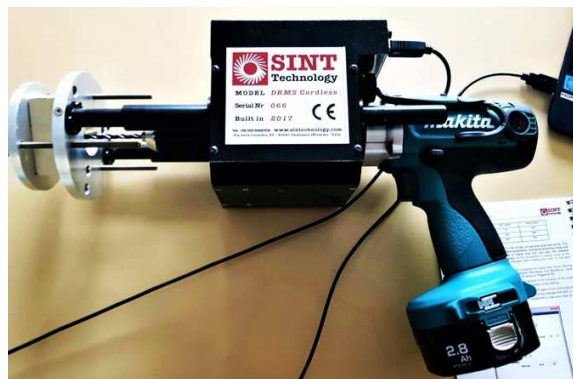
Figure 106 : Le système de mesure de résistance au perçage utilisé sur les échantillons d'enduit
