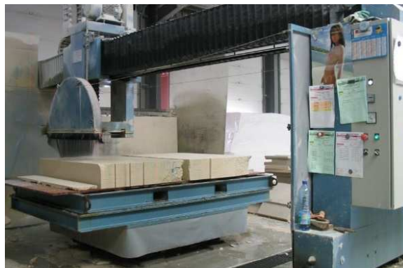
Figure 12 : Sciage des pierres de tuffeau, carrière Maquignon (Vienne)
