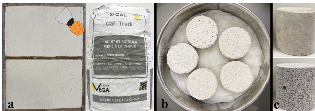
Figure 52 : (a) L'enduit d'accroche distribué par VEGA; (b) La démarche suivie pour l'humidification des supports. En pratique, les supports sont préalablement collés à la pastille métallique ; (c) Les échantillons de tuffeau et de siporex pour le test d'imbibition
