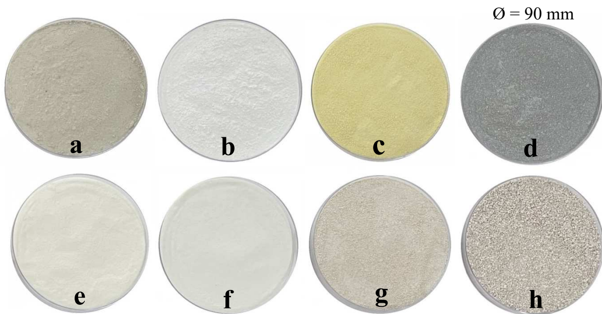
Figure 11 : (a) Poudre de tuffeau ; (b) Chaux aérienne ; (c) Superplastifiant ; (d) Compensateur de retrait ; (e) Entraîneur d'air ; (f) Agent colloïdal ; (g) Sable calcaire fin ; (h) Sable calcaire gros
