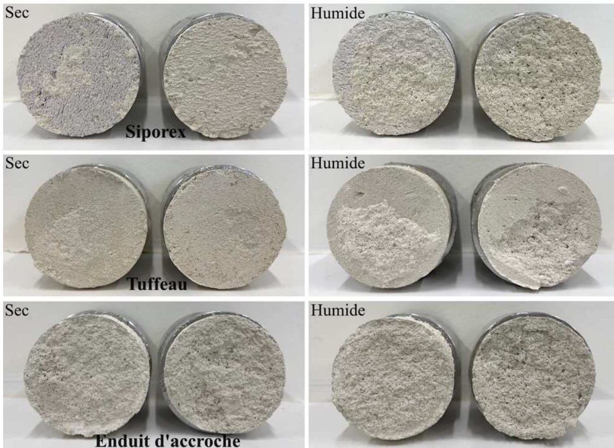
Figure 105 : Effet de l'humidification des supports poreux utilisés sur l'adhérence de la formule optimale (OPT)
