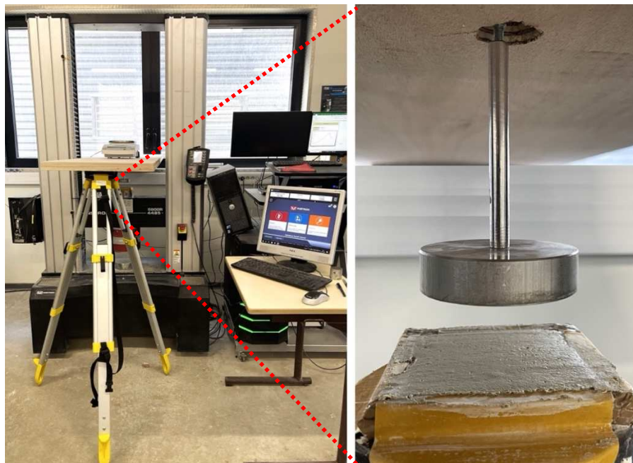
Figure 47 : Dispositif utilisé au laboratoire pour la mesure de l'adhérence à l'état frais
