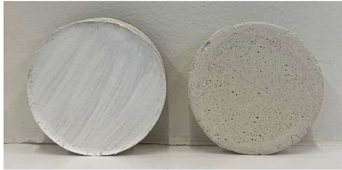
Figure 96 : Un échantillon représentatif de la formule REF qui s'est détaché du support en BA13 peint avant la réalisation de l'essai d'adhérence
