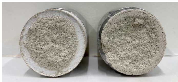
Figure 98 : Rupture cohésive d'un échantillon représentatif de la formule OPT après la réalisation de l'essai d'adhérence sur le support en BA13 peint
