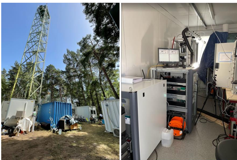
Figure IV-5 : Photographies du site de mesures (à gauche) et du conteneur du manifold où était installée la baie TD-GC-FID/MS (à droite)
