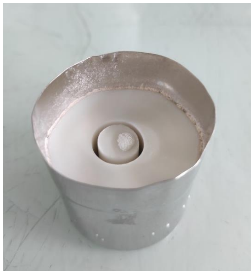
Figure 70 - Creuset de l'échantillon SBN-M5 post mortem présentant une séparation de phase secondaire. Une légère forme de bol est visible vers le milieu de la surface, avec une matière blanche poudreuse qui correspond à la phase macroscopique.
