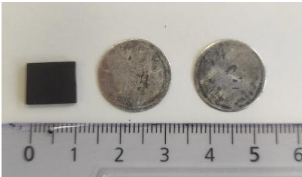
Figure 72 - Echantillon métallisé à l'encre de Pt (gauche) avec ses deux disques de platine (droite).
