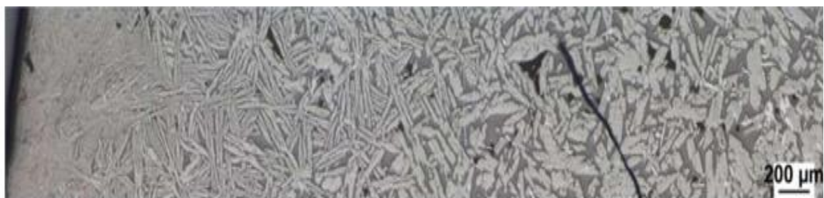
Figure 1-5 Evolution microstructurale d'un matériau industriel [22]. A gauche, la surface du lingot (peau) en contact avec le moule. A droite, vers le cœur du lingot.
