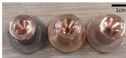
Figure 2-3 Différentes buses convergentes-divergentes en cuivre avec des ouvertures variant de 1mm (à gauche) à 5mm. L'échantillon est placé à l'intérieur du cône divergent et la taille d'ouverture de la buse est adaptée pour permettre une lévitation stable de l'échantillon en fonction de sa masse propre.
