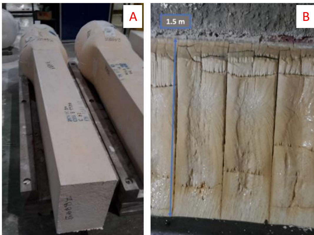
Figure 1-3 Matériau industriel AZS en sortie de production (A) [22] et en fin de vie de four (en moyenne 15 ans) (B) [23].
