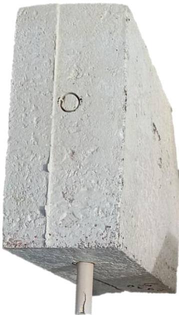
Figure 2-1 Présentation d'un bloc de contrôle en cours de carottage, (B) d'un schéma de bloc de contrôle et de la représentation de son refroidissement et (C) d'un schéma de bloc de contrôle et de la carotte non prélevée.
