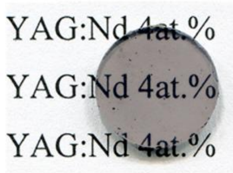
Figure I.4. Céramique transparente de Nd :YAG. D'après D.U. Kosyanov 39
