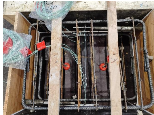
Figure 31 : dalle instrumentée par des échelles de thermocouples pour les essais au four à gaz
