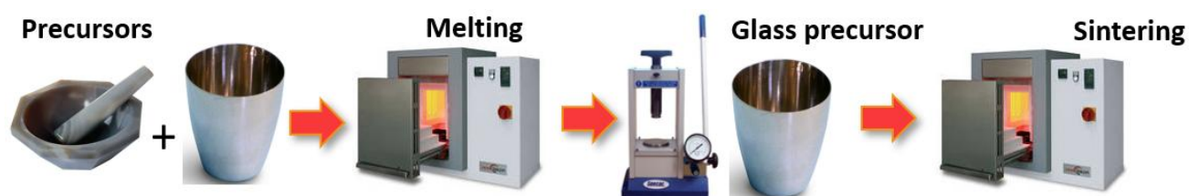
Fig. A.1. Schéma de l'approche de la cristallisation du verre utilisée dans ce travail.
