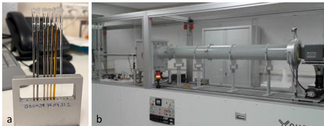
Figure 2-10 : (a) Ligne Xeuss SAXS/GISAXS/WAXS au laboratoire ICMN. (b) Photos des capillaires contenant le liquide (polyol + NPs).
