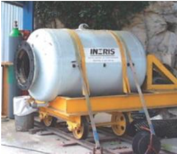
Figure I. 11 - Le récipient de 1m 3 (ISO 6184/1) et la sphère de 20 L(EN14034)[31]
