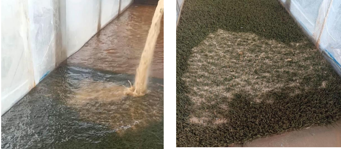
Figure 5. 5 : Transport et dépôt des sédiments lors des essais en canal végétalisé
