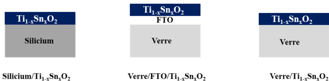
Figure IV-8: Les échantillons de \text{Ti}_{1-x}\text{Sn}_x\text{O}_2 déposés par co-pulvérisation magnétron réactive sur substrats de silicium, FTO et Verre.
