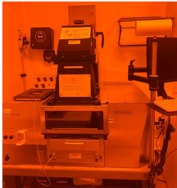
FIGURE 2.24 – Photographie de l'équipement de photolithographie utilisé au cours de cette thèse : MA6 de SUSS MicroTec en salle blanche au GREMI.
